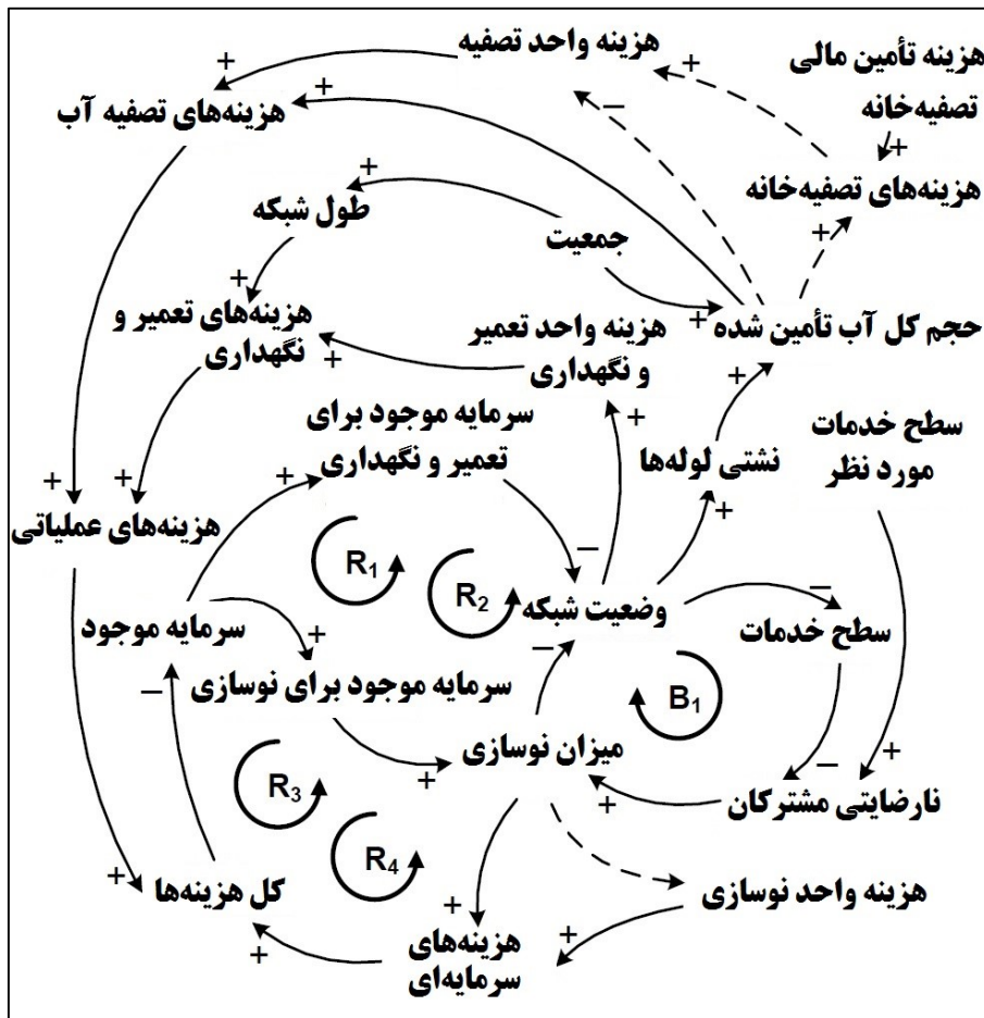
شکل ۳. نمودار حلقه علی بخش لوله‌های انتقال آب در سیستم توزیع آب شهری (رهان، ۲۰۱۳)
